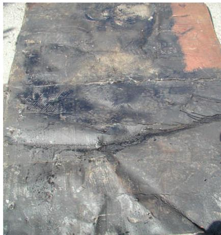
vecchia membrana bituminosa con evidenti fessurazioni
